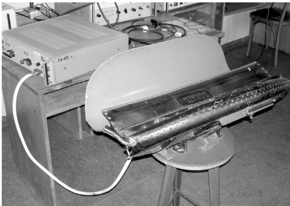
Рис. 7.1. Вид передающей зеркальной антенны.
