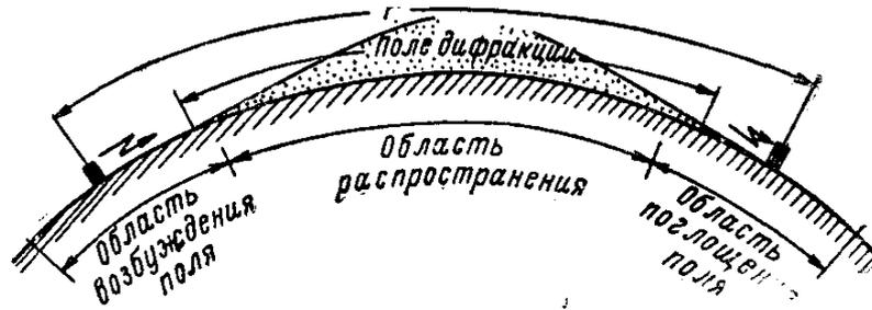
Рис. 4.5. К расчету поля дифракции на поверхности Земли.
