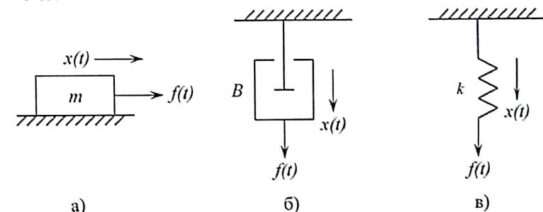
Рис. 4.2 – Найпростіші механічні системи переміщення: а) маса; б) тертя; в) пружність
