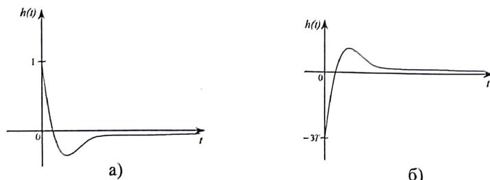
Рис. 6.7 – Графіки перехідної (а) і вагової (б) функцій для прикладу 6.28
