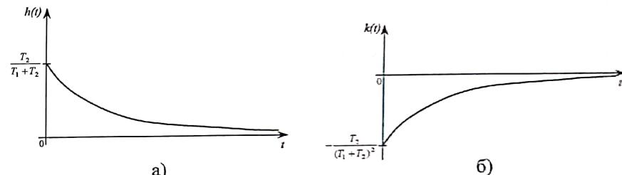
Рис. 6.5 – Графіки перехідної (а) і вагової (б) функцій для прикладу 6.2а
