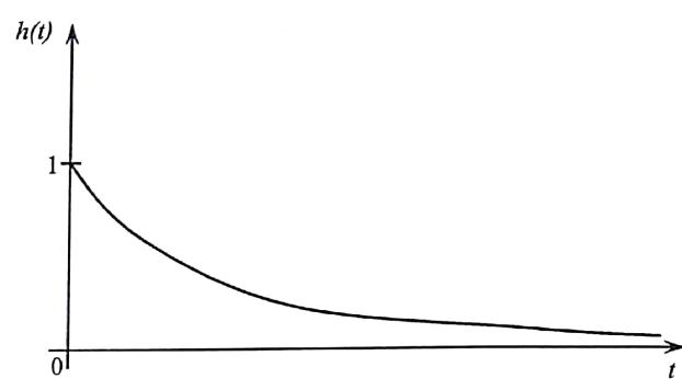
Рис. 6.3 – Графік перехідної функції  $h(t)$  для прикладу 6.1
