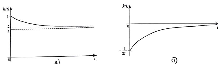
Рис. 6.6 – Графіки перехідної (а) і вагової (б) функцій для прикладу 6.26
