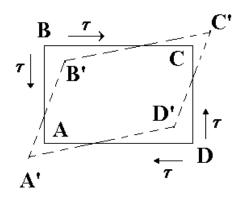
Модуль Юнга E и коэффициент Пуассона  $\mu$  полностью характеризуют упругие свойства изотропного материала. Все прочие характеристики могут быть выражены через E и  $\mu$ . Рассмотрим куб из однородного и изотропного вещества. Приложим к противоположным граням его равные и противоположно направленные силы. Под действием приложенных
