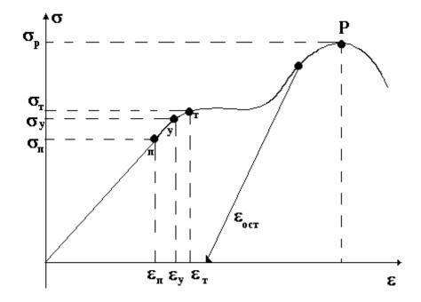
Зависимость возникающего в теле напряжения, от величины деформации  $\varepsilon$  представлена на рисунке. При небольших значениях, напряжение  $\sigma$  и деформация  $\varepsilon$  примерно пропорциональны друг другу (до точки  $\Pi$ ). На этом участке справедлив закон Гука: деформация прямо пропорциональна напряжению:
