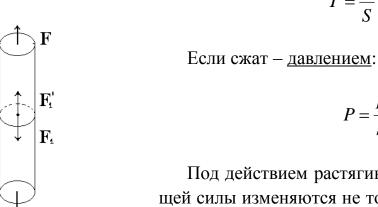
Под действием растягивающей или сжимающей силы изменяются не только продольные, но и поперечные размеры стержня. В случае растягивающей силы они уменьшаются, в случае
