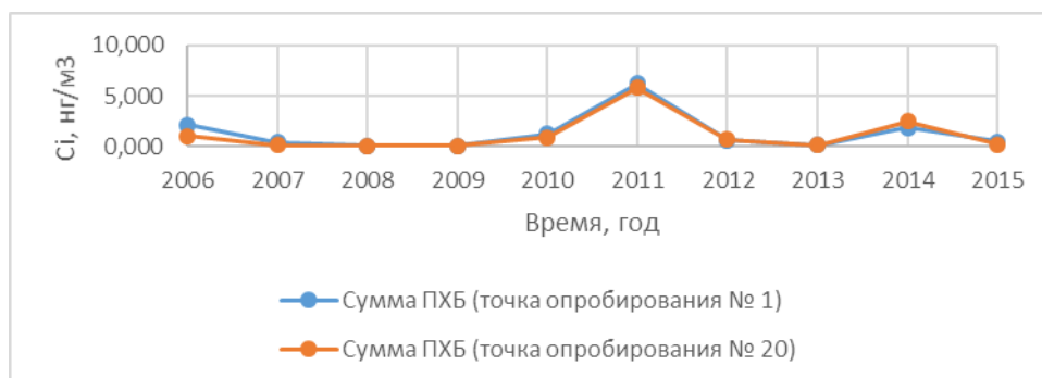
Рисунок 4 – График изменчивости концентраций суммы ПХБ в атмосферном аэрозоле осенью за 2006 – 2015 гг.
