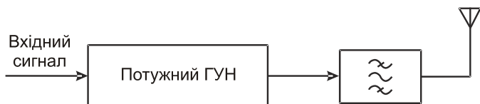
Рис. 4.32. Побудова передавача з потужним генератором, що управляється напругою (ГУН)
