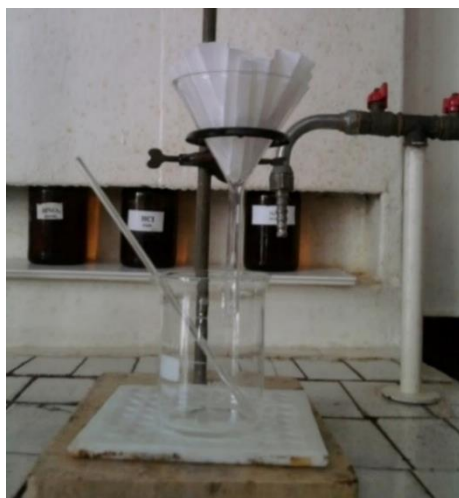
Рис. 5.1 – Прилад для перекристалізації органічної речовини з неорганічного розчинника
