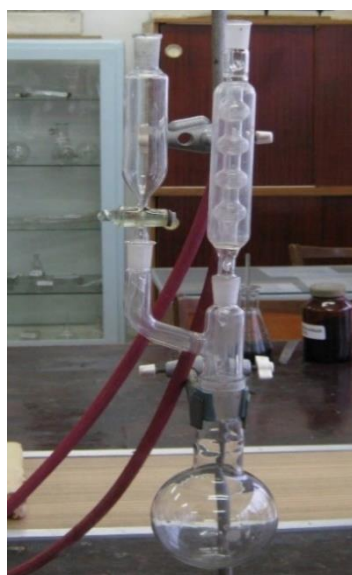
Рис. 5.2 – Прилад для перекристалізації органічної речовини з органічного розчинника
