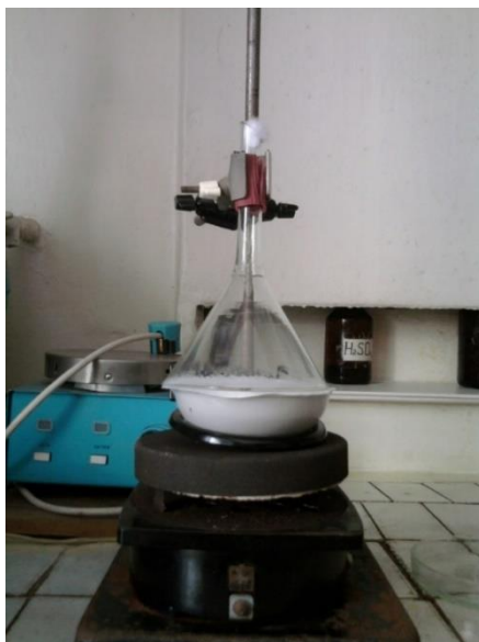
Рис. 5.3 – Прилад для сублимації (возгонки) органічної речовини
