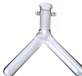
Прилад Ландольта (ще називають «реакційна пробірка Оствальда»)
