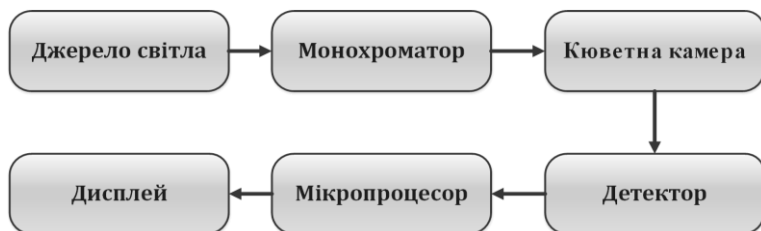
Рис. 2 – Блок-схема спектрофотометра 722
